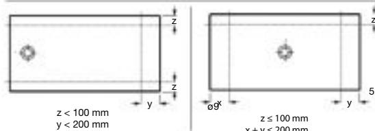
Los lados cortados deben ir a pared o enrasados en el plano suelo. Posibilidad de corte: ver dibujo.
